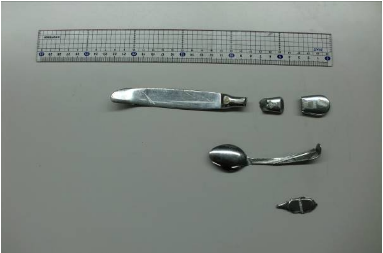
生ごみ破碎機に挟まっていたもの
