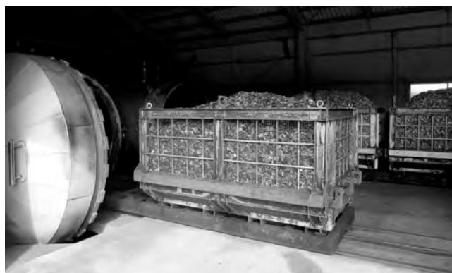
チップにした木材を蒸す圧力窯
